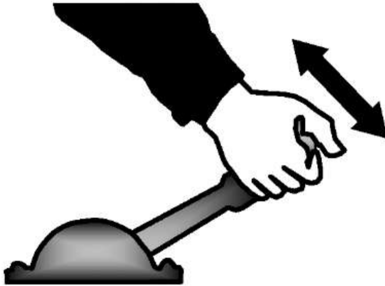
Рис. 1.9. Положение правой руки на стояночном тормозе
